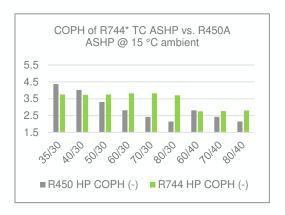
AT HIGHER FLOW TEMPERATURES THE CO<sub>2</sub> HEAT PUMP DELIVERS SIGNIFICANTLY BETTER PERFORMANCE
